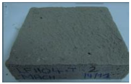
Echantillon de l'enduit à base de super-isolant
