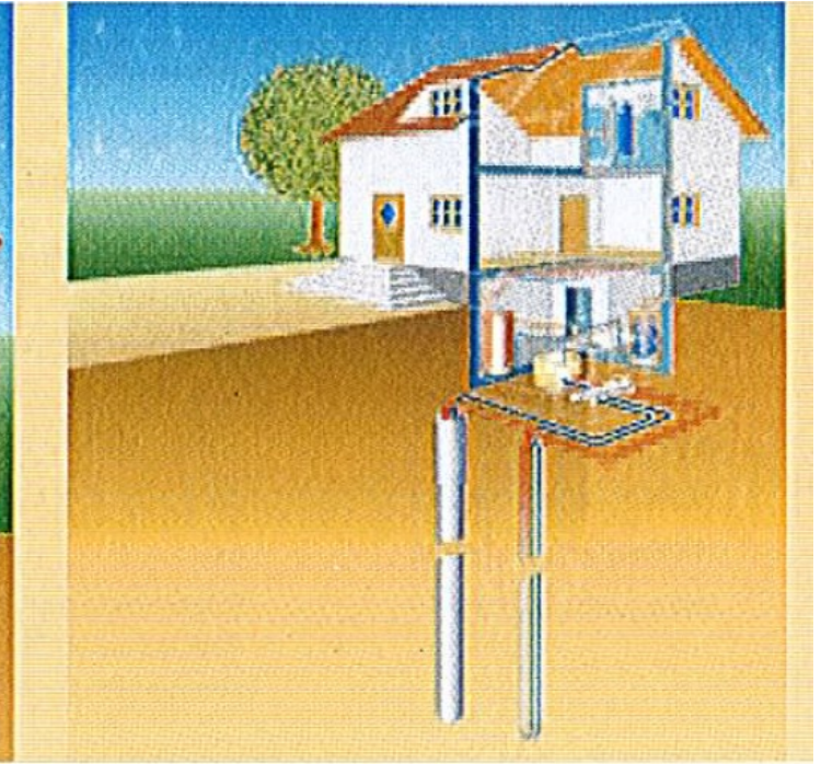
Abb. 24 Schema einer Erdreich/Wasser-Wärmepumpe
