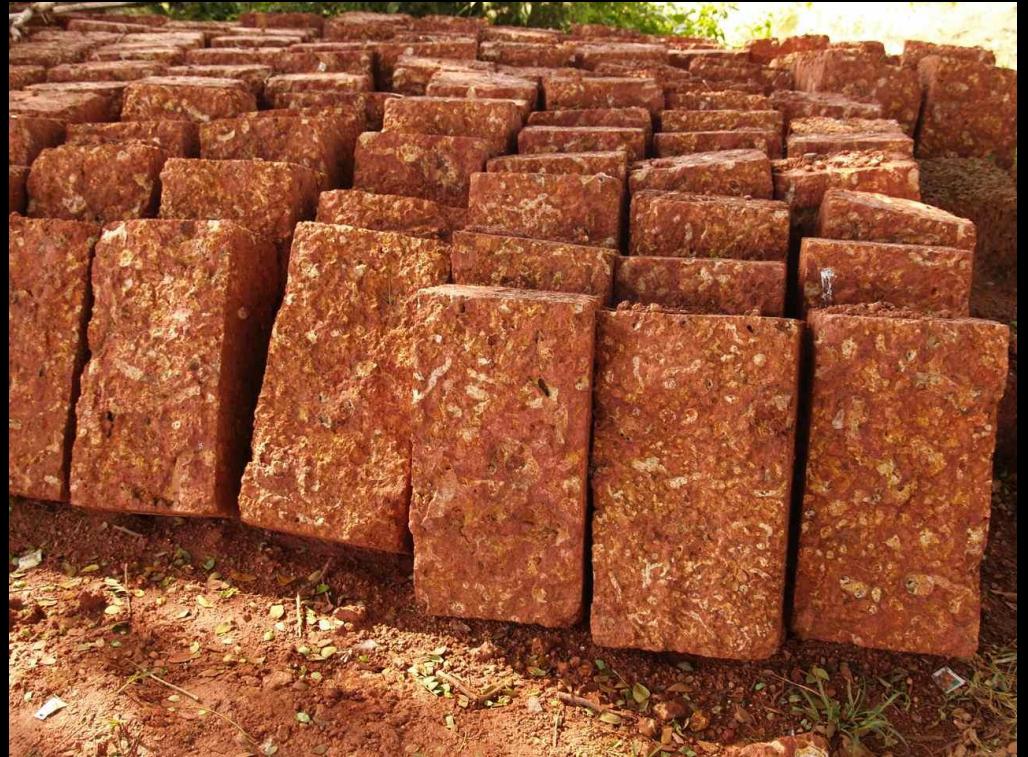
blocs de construction en latérite, Orissa, Inde
