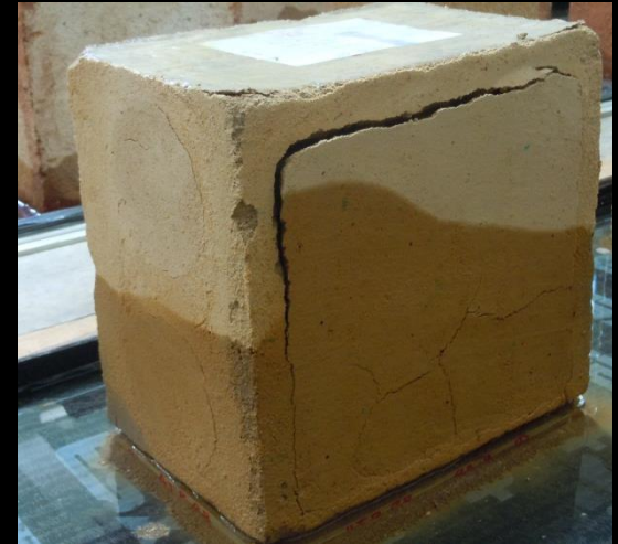
Av + mortier de terre-standard avec ciment naturel
