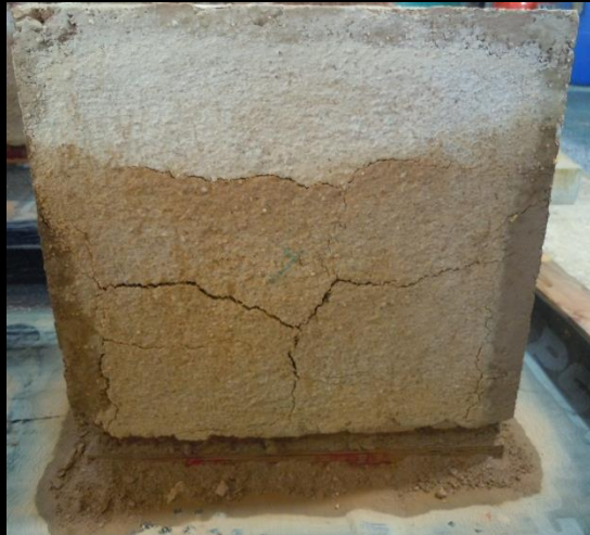
VC + mortier de terre-standard avec chaux aérienne
